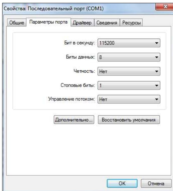
2. Далее необходимо зайти в настройки модемов и телефонов, выбрать модем и создать соединение (выбрать из списка самим) «последовательный кабель для соединения компьютеров» и указать свой COM-порт.
