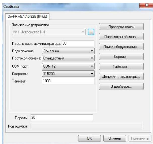
В открывшемся окне нажмите кнопку «Поиск оборудования...». Произведите поиск всех подключенных к ПК ККТ, нажав на кнопку «Начать поиск». Запомните настройки обмена данными с найденным ККТ. Закройте окно «Поиск оборудования» и выберите в поле «Порт»
